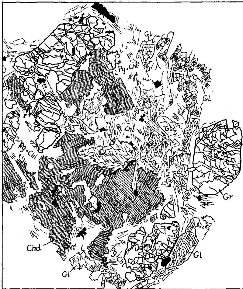
Fig. 1. Chloritoidführender Granat (Gr)-Glaukophanschiefer vom Mellichengletscher (Täschthal). Dünnschliff. 10\times vergr. Chloritoid (Chd) und Glaukophan (Gl) sind korrodiert und z. T. in Paragonit (Pg) + Chlorit (Chl) umgewandelt.
