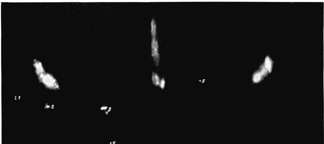
Fig. 4. Photogoniogramm des deformierten und rekristallisierten Bleiglanzes. Die kürzere Seite ist der optischen Achse des Photogoniometers parallel.
