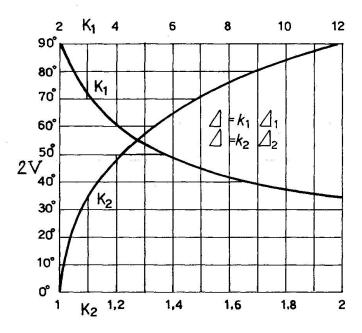
Fig. 10. Nomogramm zur Bestimmung der Faktoren  $k_1$  und  $k_2$ , die zur Berechnung der maximalen Doppelbrechung  $\Delta$  aus den Doppelbrechungen  $\Delta_1$  auf  $IB_1$  und  $\Delta_2$  auf  $IB_2$  dienen. Abszissen =  $k_1$  (oben) und  $k_2$  (unten). Ordinaten = 2V (nach Fig. 8 aus Q bestimmt).
