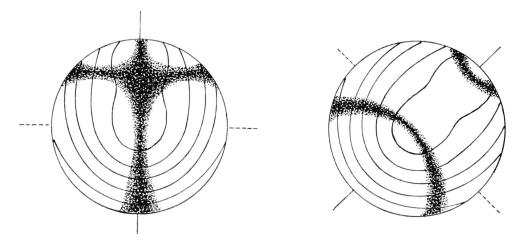
Fig. 12. Monosymmetrisches Interferenzbild  $IP_{12}(AA)$ . Der Symmetriedurchmesser (Striche am Rande) entspricht der Spur der optischen Achsenebene und einer der beiden Schwingungsrichtungen. Die dazu senkrechte andere Schwingungsrichtung (gestrichelt) ist keine Symmetrielinie. Im Beispiel sind  $\delta A' = 0$ ,  $\delta A'' = 0.88$ ,  $\delta B_1 = 0.46$ . Bei einem n = 1.48 ergibt sich aus diesen Werten mit Hilfe der Abbildung 7  $2V = 30^{\circ}$ .
