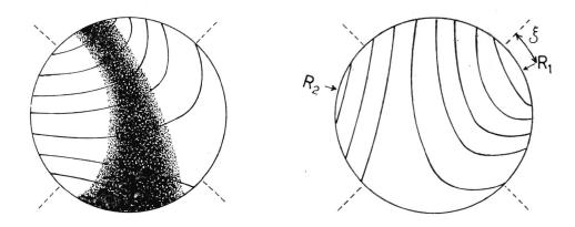
Fig. 21. Asymmetrisches Interferenzbild IS. Die extremen Gangunterschiede  $R_1$  und  $R_2$  liegen nicht mehr diametral gegenüber. Auch hier gilt  $Q = R_1/R_2$ . Der Asymmetriewinkel zwischen dem durch  $R_1$  gelegten Radius und der benachbarten Schwingungsrichtung beträgt hier  $\xi = 18^{\circ}$ .
