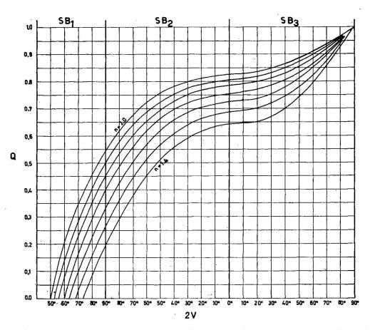
Fig. 8. Nomogramm zur Bestimmung der Beobachtungsrichtung in den disymmetrischen Interferenzbildern IB und zur annähernden Bestimmung von 2V auf Grund der Q-Werte. Abszissen = 2V in IB<sub>1</sub>, IB<sub>2</sub> und IB<sub>3</sub>. Ordinaten =  $Q = R_1/R_2$ . Bezugskurven für verschiedene Brechungsindizes n.
