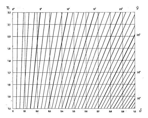
Fig. 7. Nomogramm zur Bestimmung des Neigungswinkels  $\nu$  einer optisch ausgezeichneten Richtung (A oder B) zur Mikroskopachse. Abszissen = Zentralabstände  $\delta A$  oder  $\delta B$ ; Ordinaten = n. Die geneigten Linien ergeben  $\nu$ . Im Falle einer IB<sub>1</sub>(AA) entspricht  $\nu$  dem halben Achsenwinkel V.
