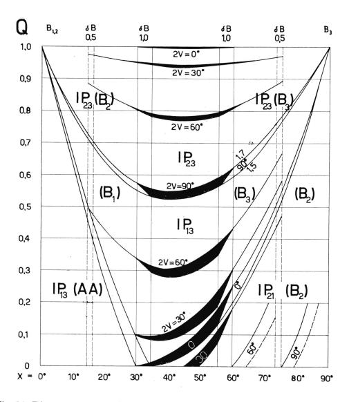
Fig. 18. Diagramm zur semiquantitativen Interpretierung der monosymmetrischen Interferenzbilder IP. Abszissen = Winkelabstände der Beobachtungsrichtungen von B<sub>1</sub> oder B<sub>2</sub> aus gegen B<sub>3</sub> hin gemessen. Ordinaten = Q-Werte. Alle Bezugskurven für 2V, δA und δB sind für n=1,5 und n=1,7 eingetragen. Sie begrenzen die Felder der verschiedenen Typen der IP.
