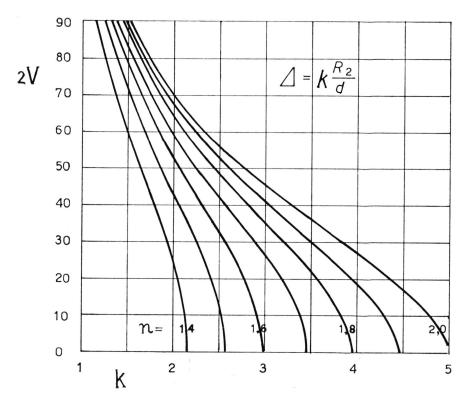
Fig. 11. Nomogramm zur Bestimmung der maximalen Doppelbrechung  $\Delta$  auf Grund des Gangunterschieds  $R_3$  (s. Fig. 3) in  $IB_1(AA)$  oder  $IB_1$ . Abszissen = Faktor k; Ordinaten = 2V; Bezugskurven für verschiedene Brechungsindizes n.
