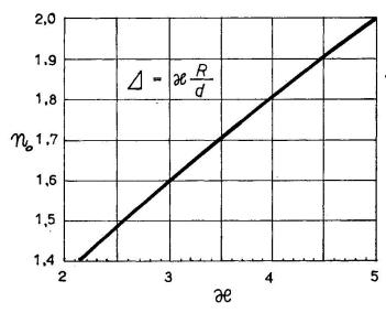
Fig. 2. Nomogramm zur Bestimmung der maximalen Doppelbrechung  $\Delta$  in IA. Abszissen = Faktor  $\kappa$ , mit dem der Quotient R/d multipliziert werden muss, um  $\Delta$  zu erhalten. Ordinaten = Brechungsindizes  $n_0$ .
