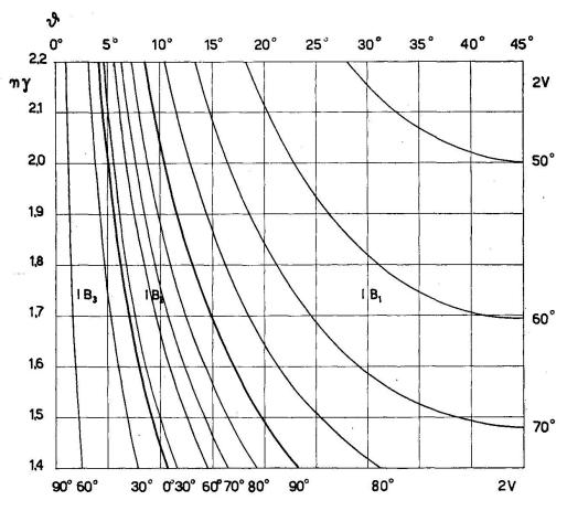
Fig. 9. Nomogramm zur Bestimmung der Beobachtungsrichtung in den disymmetrischen Interferenzbildern IB und zur rohen Schätzung von 2V auf Grund des "Fluchtwinkels"  $\vartheta$  der Isogyren. Abszissen = Fluchtwinkel  $\vartheta$ ; Ordinaten = Brechungsindizes n. Kurven = 2V in IB<sub>1</sub>, IB<sub>2</sub> und IB<sub>3</sub>.
