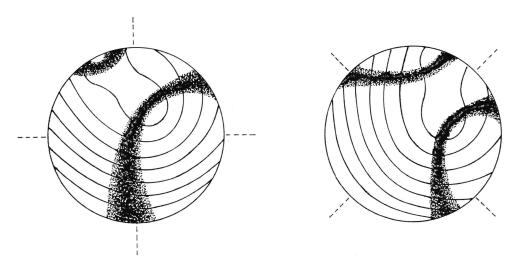
Fig. 19. Asymmetrisches Interferenzbild IS (AA).  $\delta A' = 0.38$ ;  $\delta A'' = 0.86$ ;  $\delta B_1 \sim 0.6$ . 2V kann leicht geschätzt werden. Misst man mit Hilfe des drehbaren Mikroskoptisches den von den durch A' und A'' gehenden Radien gebildeten Winkel und liest in Fig. 7 die den  $\delta A'$  und  $\delta A''$  entsprechenden Winkel ab, so kann 2V berechnet oder graphisch bestimmt werden.
