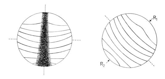
Fig. 16. Monosymmetrisches Interferenzbild IP<sub>13</sub>. Symmetriedurchmesser = Spur der Ebene P<sub>13</sub>. Auf ihm liegen am Rande der kleinste (R<sub>1</sub>) und der grösste (R<sub>2</sub>) Gangunterschied.  $Q = R_1/R_2$ .
