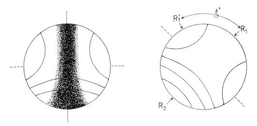
Fig. 17. Monosymmetrisches Interferenzbild IP<sub>23</sub>. Symmetriedurchmesser = Spur der Ebene P<sub>23</sub>. Darauf liegen am Rande die R<sub>1</sub> und R<sub>3</sub>.  $Q = R_1/R_2$ .
