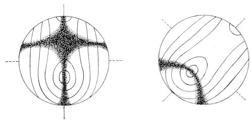
Fig. 13. Monosymmetrisches Interferenzbild  $IP_{12}(A)$ . Symmetriedurchmesser = Spur der Achsenebene  $P_{12}$ . Im Beispiel ist  $\delta A = 0.37$ ,  $\delta B_1$  ungefähr 0,4. Die konvexe Seite der Isogyre in Diagonalstellung ist dem Bildmittelpunkt zugekehrt.
