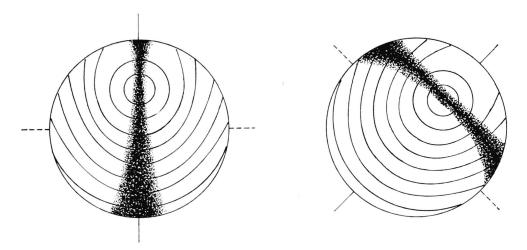
Fig. 14. Monosymmetrisches Interferenzbild IP $_{21}(A)$ . Symmetriedurchmesser = Spur der Achsenebene P $_{12}$ .  $\delta A = 0.46$ . In Diagonalstellung ist die konkave Seite der Isogyre dem Bildmittelpunkt zugekehrt. Die Beobachtungsrichtung liegt also zwischen A und B $_2$ .
