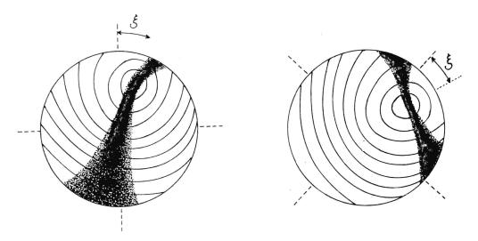
Fig. 20. Asymmetrisches Interferenzbild IS(A).  $\delta A = 0.63$ ; Asymmetriewinke  $\xi = 20^{\circ}$ .
