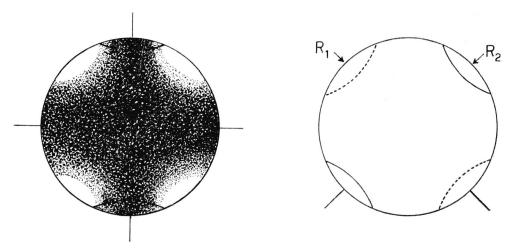
Fig. 5. Disymmetrisches Interferenzbild  $IB_3$ .  $R_1 = Gangunterschied am Rande gegen <math>B_1$ ;  $R_2 = ebenso gegen B_2$ .
