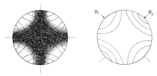
Fig. 4. Disymmetrisches Interferenzbild  $IB_2$ .  $R_1 = Gangunterschied am Rande in der Richtung von <math>B_1$ ,  $R_2 = ebenso$  in der Richtung von  $B_3$ .  $R_1$  und  $R_2$  liegen paarweise auf den Symmetriedurchmessern, die mit den Schwingungsrichtungen zusammenfallen.
