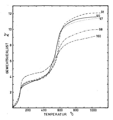
Fig. 1. TGA-Kurven der dekarbonatisierten Fraktionen  $< 2 \mu$ . 90, 91 und 97 sind Opalinustone, 98 ist Renggeri-Mergel und 160 ist Terrain à Chailles. Aufgeheizt wurde in N<sub>2</sub>-Atmosphäre mit 2,5° C pro Minute.
