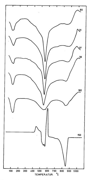
Fig. 3. DTA-Kurven: 90, 91 und 97 Opalinustone, Fraktion  $<2~\mu$ , dekarbonatisiert. 150 sandige Lagen im Opalinuston. 98 Renggeri-Mergel Fraktion  $<2~\mu$ , 160 Terrain à Chailles Fraktion  $<2~\mu$ . Alle Proben, ausser 150, in N<sub>2</sub>-Atmosphäre aufgeheizt. Aufheizgeschwindigkeit 9°C pro Minute.
