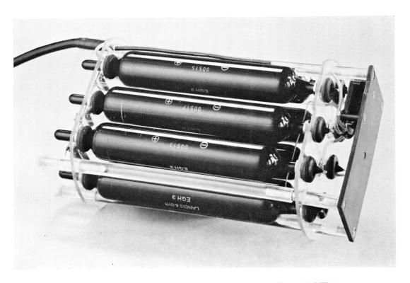
Fig. 1. Arrangement von 8 GM-Zählrohren Type EQH 3.
