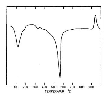
Fig. 2. DTA-Kurve der Fraktion  $< 2 \mu$ , aufgeheizt in Luft mit  $9.5^{\circ}$  C/min.
