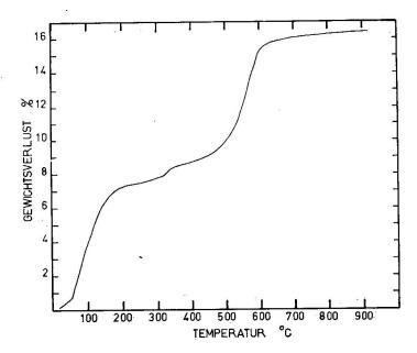
Fig. 4. Thermogravimetrische Kurve der Fraktion  $< 2 \mu$ , aufgeheizt in N<sub>2</sub>-Atmosphäre mit 2,5°C/min.
