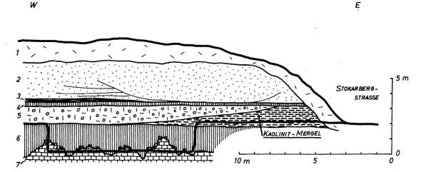
Fig. 1. Aufschluss der Baugrube Stokarbergstrasse Schaffhausen, Herbst 1960. Kaolinit-Mergel-Vorkommen.
