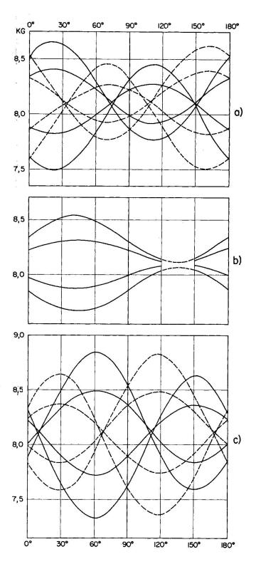
Fig. 1. Mikroklin Nr. 1, Crystal Peak. Orientierungsabhängigkeit der Quadrupolaufspaltung von Al<sup>27</sup>. Der Kristall wurde um eine Achse senkrecht zu H<sup>0</sup> gedreht.
