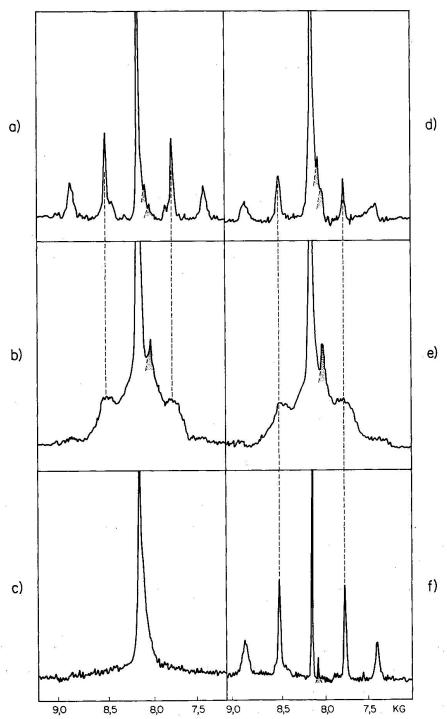
Fig. 3. Kernresonanzspektren von Mikroklin und Adular. Die Adularspektren sind spiegelsymmetrisch zu (010). Die punktierten Signale sind Zentralsignale von Na<sup>23</sup>, die bei Mikroklin in der Regel verdoppelt sind (vgl. a und d), da der ausgeschiedene Albit nach Albitgesetz verzwillingt ist.
