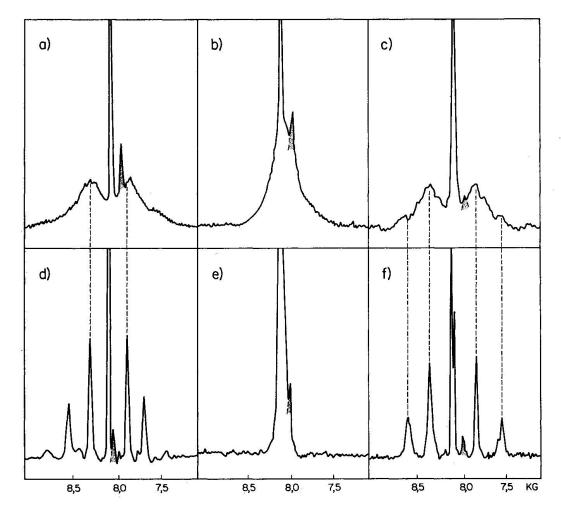
Fig. 2. Kernresonanzspektren von Mikroklin und Adular. Das Auftreten von Satelliten bei Adular zeigt, dass die Al/Si-Verteilung zumindest teilweise geordnet ist. Man erkennt, dass Adular und Mikroklin praktisch dieselbe Quadrupolaufspaltung aufweisen. Die punktierten Signale sind Zentralsignale von Na<sup>23</sup>.
