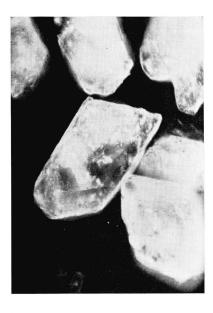
Fig. 6. Interposition mikrokristalliner (trüb-weiss) und klarer, durchsichtiger (dunkelgrau) Zirkonsubstanz in einem Kristall. Zirkon aus dem Rotondogranit, Ultropak, Vergr.  $280 \times$ .
