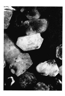
Fig. 8. Zonarbau der Zirkone (Typus a); die mikrokristallinen Bereiche sind zum Teil an einzelne Zonen gebunden. Rotondogranit, Ultropak, Vergr.  $280 \times$ .
