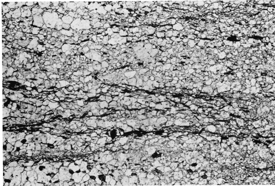
Fig. 4. Mylonit im Rotondogranit südwestlich des Chüebodenhorns. Quarz (hell, relativ gross) und Biotit (dunkel) sind rekristallisiert; Biotit ist gut ausgerichtet. Vergrösserung etwa 1 : 15.
