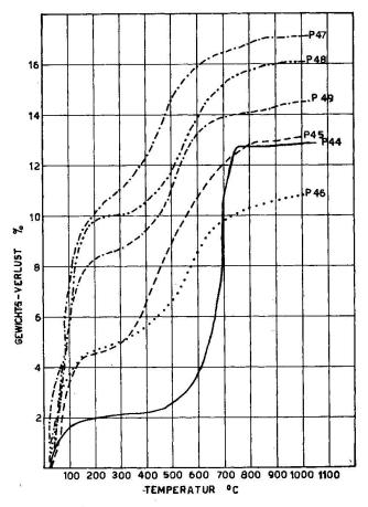
Fig. 4. Thermogravimetrische Kurven der Fraktionen <2 μ. Aufgeheizt in N<sub>2</sub>Atmosphäre mit 2,5°C/min.
