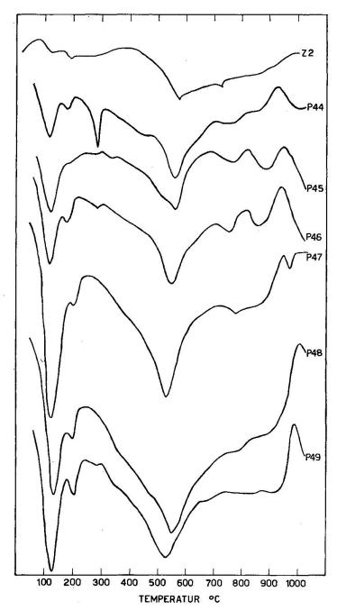
Fig. 3. DTA-Kurven. Z 2 Fraktion  $<2~\mu$ , P 44 Fraktion  $<2~\mu$ , P 45 Fraktion 2—0,5  $\mu$ , P 46, P 47, P 48 Fraktion  $<2~\mu$ , P 49 Fraktion 2—0,5  $\mu$ . Proben P 44, P 45, P 46, P 47, P 48 und P 49 in N<sub>2</sub>-Atmosphäre aufgeheizt, Z 2 in Luft. Alle Proben dekarbonatisiert. Aufheizgeschwindigkeit 9°C/min.
