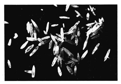
Fig. 1. Synchisit-Kristalle. Vergrösserung  $10\times$ . Bei einzelnen Kristallen sind Bastnäsit-Lamellen zu erkennen.
