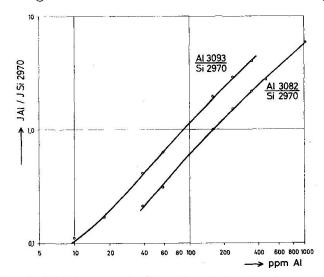
Fig. 1. Eichkurven für die Aluminiumbestimmung.
