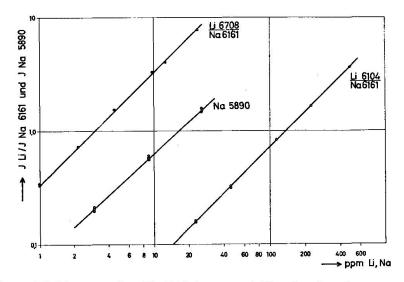
Fig. 2. Eichkurven für die Lithium- und Natriumbestimmungen.
