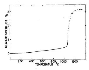
Fig. 3. Gewichtsverlustkurve von Vesuvian III: Die Kurve der Thermowaage bis 1060° C wurde durch zwei weitere Punkte einigermassen ergänzt (gestrichelte Linie).
