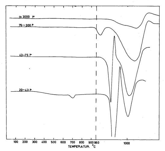
Fig. 4. DTA-Kurven verschiedener Korngrössen von Vesuvian III in  $N_2$ -Atmosphäre.
