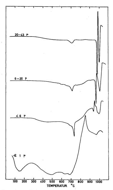
Fig. 5. DTA-Kurven verschiedener Korngrössen von Vesuvian III in N<sub>2</sub>-Atmosphäre.
