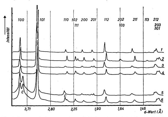
Fig. 2. Röntgenaufnahmen von Quarz (Zählrohrgoniometer), bei 20 und 600° C.
