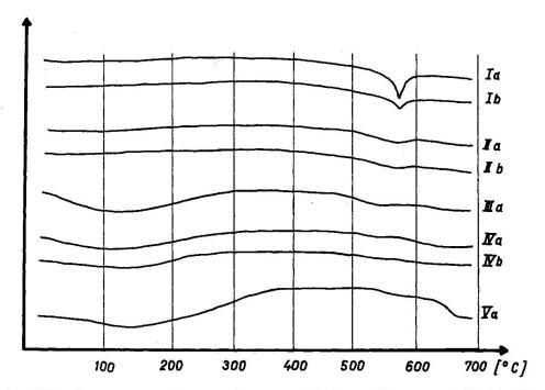
Fig. 1. DTA-Kurven von Quarzproben verschiedener Korn- und Kristallitgrösse (nach Tabelle I und II).
