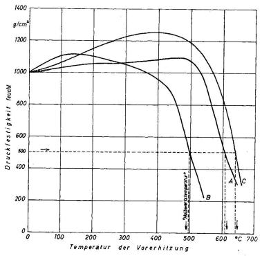
Fig. 1. Abhängigkeit der Bindefähigkeit (Druckfestigkeit feucht, formgerecht) von der Temperatur der Vorerhitzung bei Quarzsand-Prüfmischungen der Bentonite A, B und C, Na-Form. Nötiger Bentonitzusatz zu 100 % Testquarzsand für eine Ausgangsdruckfestigkeit von konstant 1000 g/cm²: A 6,6 %, B 4,6 %, C 6,3 %. Eingezeichnet ist die Methode zur Bestimmung der "Halbwerts-Temperatur", bei der die Druckfestigkeit auf 50 % des Ausgangswertes abfällt.
