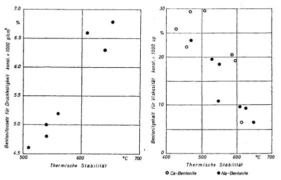
Fig. 3. Zusammenhang zwischen Bindefähigkeit (nötiger Zusatz für eine konstante Druckfestigkeit formgerecht feucht von 1000 g/cm²) und thermischer Stabilität ("Halbwertstemperatur") bei 7 verschiedenen Bentoniten (Na-Form).
