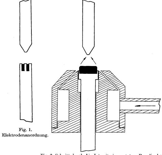
Fig. 2. Schnitt durch Air Jet mit eingesetztem Presslinghalter.
