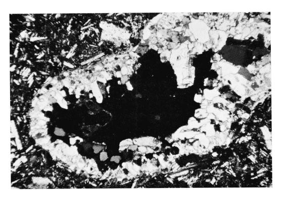
Fig. 4. Mit Kupfererzen gefüllte Mandel. Äusserster heller, feinschuppiger Saum: Serizit; innerer heller, körniger Saum: Quarz, darin Körner mit hohem Reliefi Kalzit; schwarzer Kern: Bornit und Kupferglanz, darin mit hellen Flecken: Malachit.
