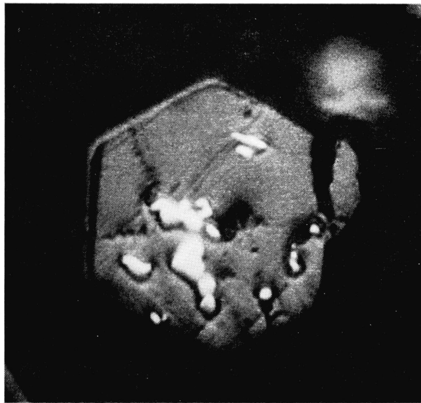
Fig. 1. \text{Cu}_5\text{FeS}_6 in KCl-LiCl-Schmelze. 6 Tage \sim 420^\circ\text{C} . Hexagonaler Basisschnitt von Idait. Pyriteinschlüsse: weiss. Vergr. 1650\times (Nachvergrößerung einer 550\times -Aufnahme), Ölimmersion.
