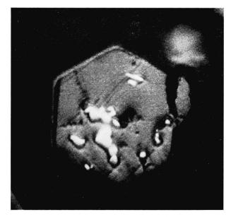
Fig. 1.  $\text{Cu}_5\text{FeS}_6$  in KCl-LiCl-Schmelze. 6 Tage  $\sim\!420^\circ$  C. Hexagonaler Basisschnitt von Idait. Pyriteinschlüsse: weiss. Vergr.  $1650\times$  (Nachvergrösserung einer  $550\times$ -Aufnahme), Ölimmersion.
