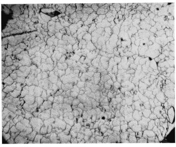
Fig. 6. Bornit (Tamaya, Chile) in 9,5% H<sub>2</sub>SO<sub>4</sub>, 19 Monate (siehe Text). Typisches Craquelée. Vergr. 550×, Ölimmersion.
