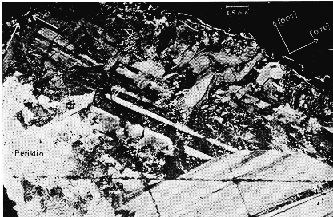
Fig. 5. Schnitt \perp[100] . Links reliktscher Periklin, recht unten ein Teil der Kernpartie (2.) mit Lamellen //[010] , von links oben nach rechts unten verlaufend Lamellen //\{110\} , wobei die dunklen Lamellen AE \approx // (010) und die hellen AE \approx \perp (010) haben. Im linken oberen Bildteil treffen sich von beiden Seiten her die Lamellen //\{110\} (in der „Projektion“ hier nahezu rechtwinklig erscheinend, siehe weisse Pfeile) in der Umgebung des stumpfen Prismenwinkels.
