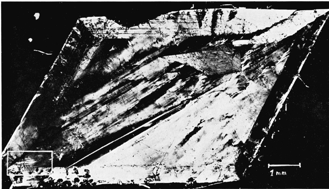
Fig. 2. Schnitt \perp[001] . Anordnung von vier Randpartien (1.) mit Lamellen //\{110\} und Kernpartie (2.) mit Lamellen //[010] . Vergrößerung von 4b. Das rechtwinklig umrandete Gebiet siehe vergrößert in Fig. 3.
