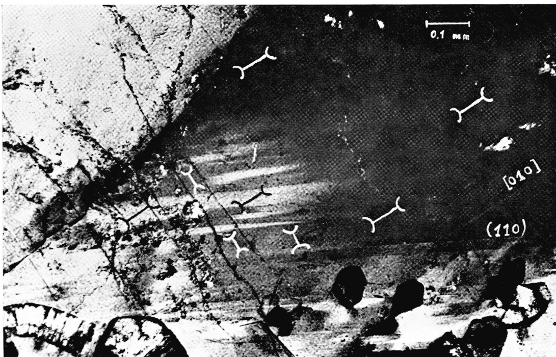
Fig. 3. Eingerahmte Partie aus Fig. 2, vergrößert. Spitz auskeilende Lamellen //\{110\} . Rechts im Bild schwach zu erkennen eine Lamelle //[010] . Eingezeichnet die Lage der optischen Achsenebenen.
