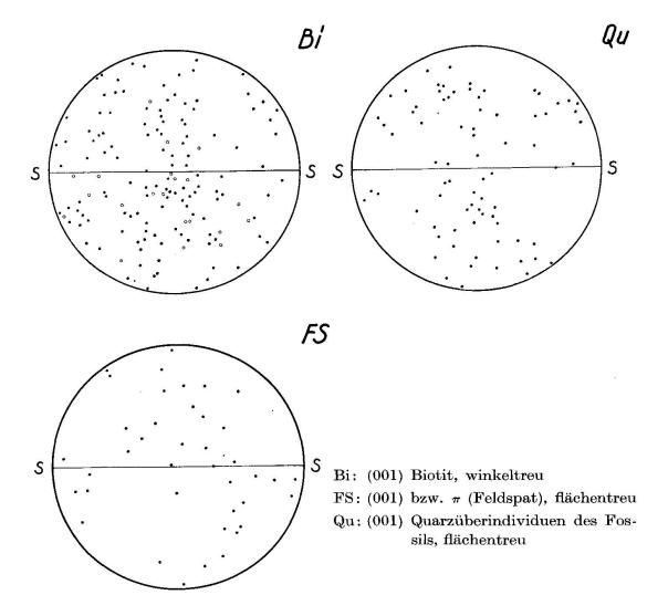
Fig. 4a-c. Das *Biotit*diagramm zeigt einen undeutlichen Gürtel mit starker zentraler Häufung, also dort, wo die Fältelung aussticht. Die im Diagramm eingetragenen Kreise bezeichnen ausgesprochen grosse (3—5 mm grosse) Biotitindividuen.
