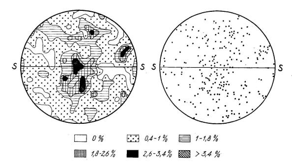
Fig. 5a u. b. Quarzsammeldiagramm des Wirtsgesteins, flächentreu. — Die Schieferung ist horizontal gestellt, die Lineation läuft längs der Spur der Schieferung in der Zeichenebene, die Fältelungsachse steht zentral im Diagramm.
