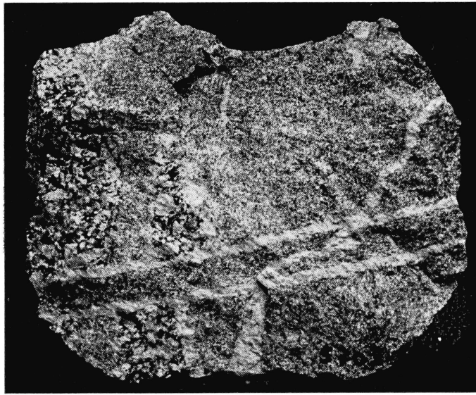
Fig. 7. Grob-porphyrische und feinkörnige Varietät des Bergeller Granodiorites, von Quarz-Feldspatadern durchzogen (Probe 7/8, Albigna-Druckstollen). \frac{1}{5} natürliche Grösse.
