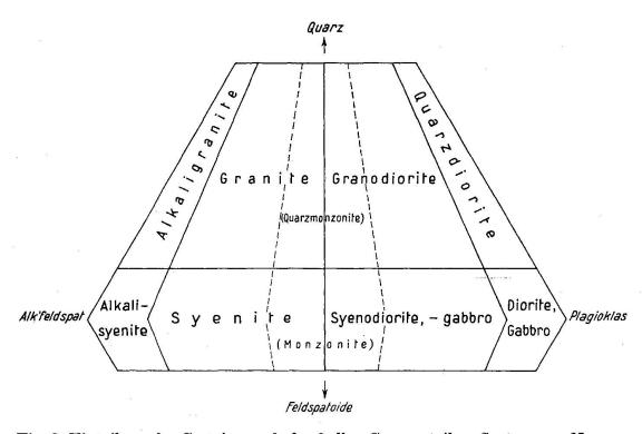
Fig. 3. Einteilung der Gesteine nach den hellen Gemengteilen, System von Niccli.
