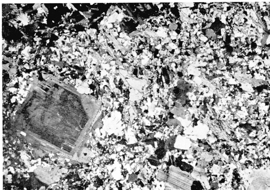
Fig. 6. Dunkle Scholle mit Plagioklasporphyroblasten (Probe 1, Albigna-Druckstollen). Vergr. 10\times .
