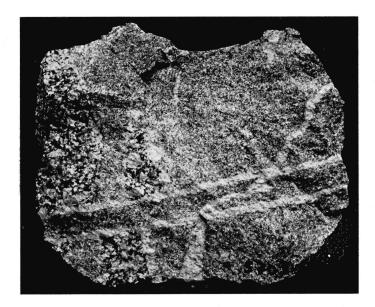
Fig. 7. Grob-porphyrische und feinkörnige Varietät des Bergeller Granodiorites, von Quarz-Feldspatadern durchzogen (Probe 7/8, Albigna-Druckstollen).  $^{1}/_{5}$  natürliche Grösse.
