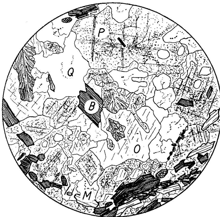
Fig. 3. Echantillon 262. Gneiss monzonitique quartzique rubané à deux micas, à plis symmigmatiques. Dessin d'une partie leucocrate: Orthose (O), Plagioclase (P), Quartz (Q), Biotite (B), Muscovite rare (M). Myrmécite, apatite, zircon. (G = 15 ×) (Voir photo 13.)
