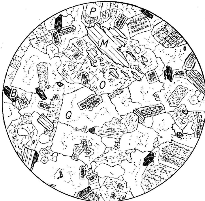
Fig. 10. Echantillon 12 G. Granite aplitique à deux micas. Orthose (O), quartz (Q), Plagioclase 5—10% An (P), Biotite chloritisée (B), Muscovite (M). (G = 15×)
