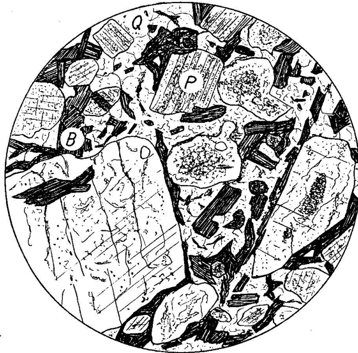
Fig. 8. Echantillon 231. Nébulette tourbillonnaire dioritique quartzique. Plagioclase 27% An (P), Biotite (B), Quartz (Q). (G = 15×)
