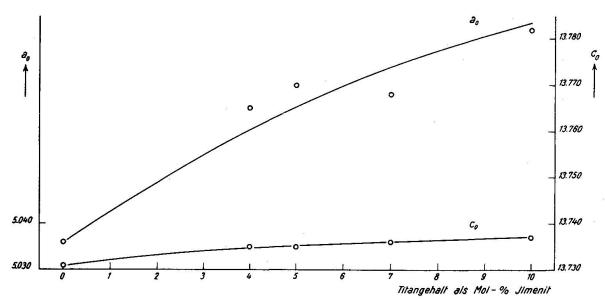
Fig. 3. Gitterkonstanten alpiner Klufthämatite in Abhängigkeit vom Titangehalt.
