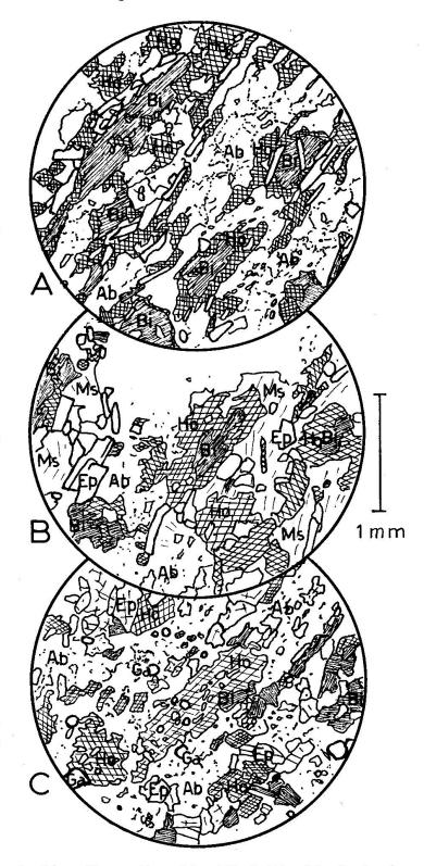
Fig. 7. Stellenweise schwach feststellbare Altersfolge Biotit-Hornblende in den basischen Gesteinen (Erläuterung der Abkürzungen S. 405).
