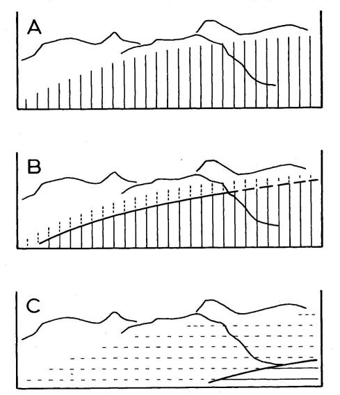
Fig. 4. Absinken der Grenze zwischen rigider und plastischer Deformation und zeitliche Abfolge der Deformationsstile im Phengitgneis.
