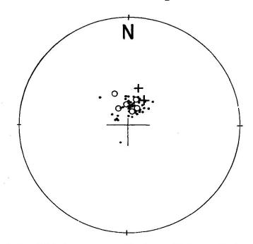
Fig. 5. Vergleich der Schieferungs- und Bankungsflächen mit den primären Kontaktflächen Phengitgneis-Paragneis im Gebiet der Staumauer. Stereographische Projektion, obere Halbkugel.
