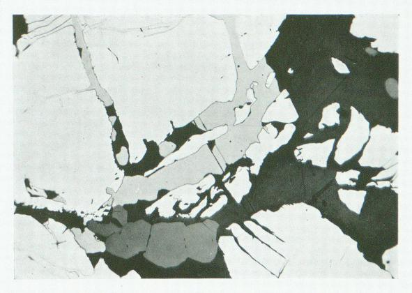
Abb. 5. Ältester Pyrit (weiss) wird resorbiert von Kupferkies (hellgrau), beide werden resorbiert von Bornit (schwarz) mit Fahlerzeinschlüssen (dunkelgrau). 1 Nicol. Ölimmersion. Vergr.  $150 \times$ . Mürtschenalp.
