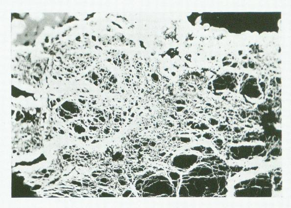
Abb. 6. Filigranartige Netzstruktur von Pyrit (weiss), wahrscheinlich tektonisch bedingt, mit Zinkblendeeinschlüssen (grau, oben links). 1 Nicol. Vergr. ca. 280 ×. Mürtschenalp.
