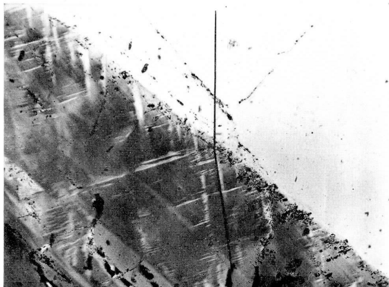
Fig. 1. Adular aus dem Tobel Drun (Tavetsch), Schnitt parallel (001). Der trikliner Saum erscheint dunkel, das homogene Innere hell. Die Grenzfläche ist (\bar{1}10) . Eingezeichnet sind die Auslöschungsschiefen, im Innern parallel (010), aussen um 9^\circ geneigt dazu. Gekreuzte Nicols, 40\times .
