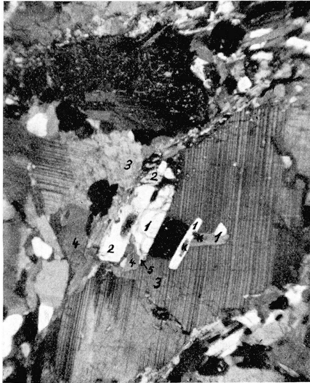
Fig. 30. Idiomorphe Epidotkristalle im Plagioklas. Augengneis, Val Ruscada. Dünnschliff Nr. 50, Vergr. 26:1, \times Nicols.
