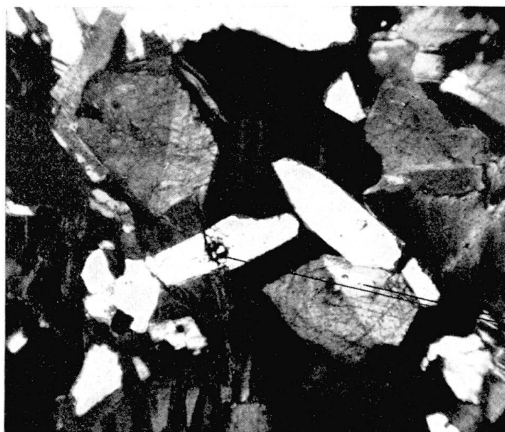
Fig. 12. Idiomorphe, zum Teil nach (100) verzwilligte Epidotkristalle in Biotit eingeschlossen. K-Orthitkerne. Epidot-Tonalit, Weg Biscia-San Iorio.
