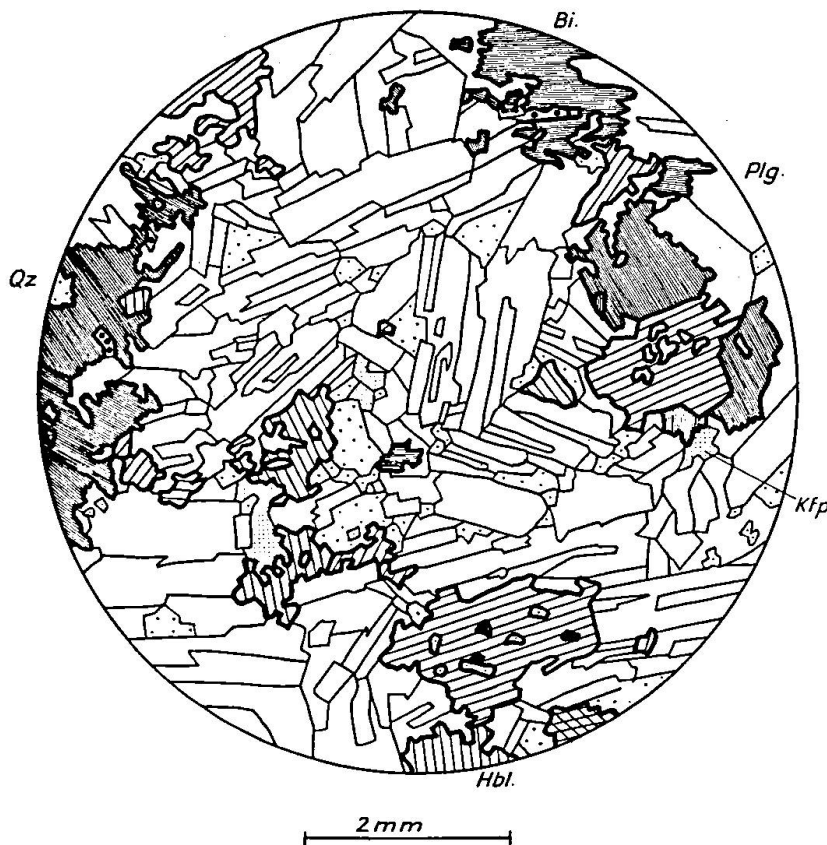
Fig. 10. Strukturbild eines massigen Tonalites mit sperrigem Plagioklasgefüge (ophitartig). Dünnschliff Nr. D 13, Alpe di Cugn.
