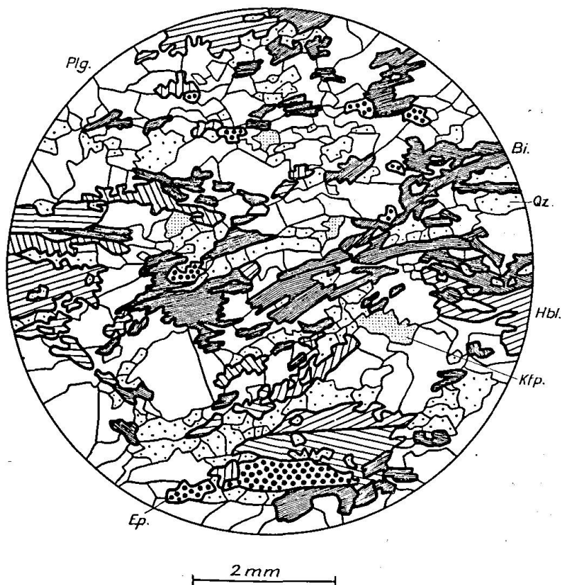
Fig. 23. Beispiel eines Strukturbildes von mittelkörnigem Epidot-Tonalitgneis. Dünnschliff Nr. 190, Weg Biscia-San Iorio.
