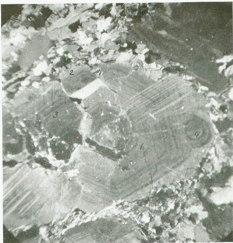
Fig. 11. Durch Kataklase gebrochenes Plagioklasauge. Die abgebrochenen Teile 2 und 3 sind in ihrer Lage verschoben worden. Die Protuberanz 4 wurde durch ein verzwillingtes Plagioklas-korn verursacht, welcher im Laufe des Wachstums des Haupt-individuums 1 an diesen haften blieb und in dasselbe eingebaut wurde. Augengneis, Dubino. Dünnschliff Nr. 246, Vergr. 26 : 1, \times Nicols.
