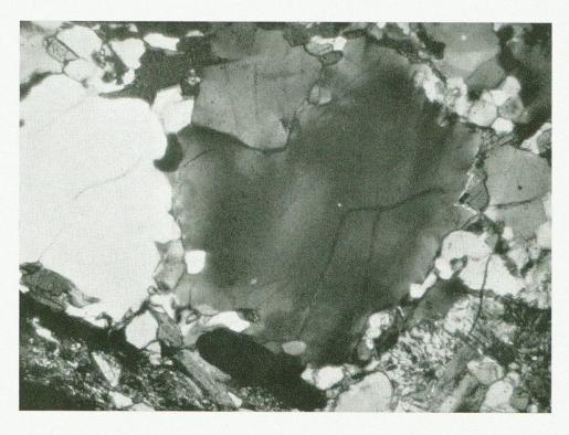
Photo 2. Echantillon 82/A/O/B. Grande plage de feldspath potassique voisine de Sng, formée de parties lisses a et de parties treillissées b s'éteignant très différemment. Parties lisses a: orthose normale, 2 V =  $-60^{\circ}$ . Parties treillissées b: orthose triclinique, 2 V =  $-73^{\circ}$ . Nicols croisés. G =  $45 \times$ .
