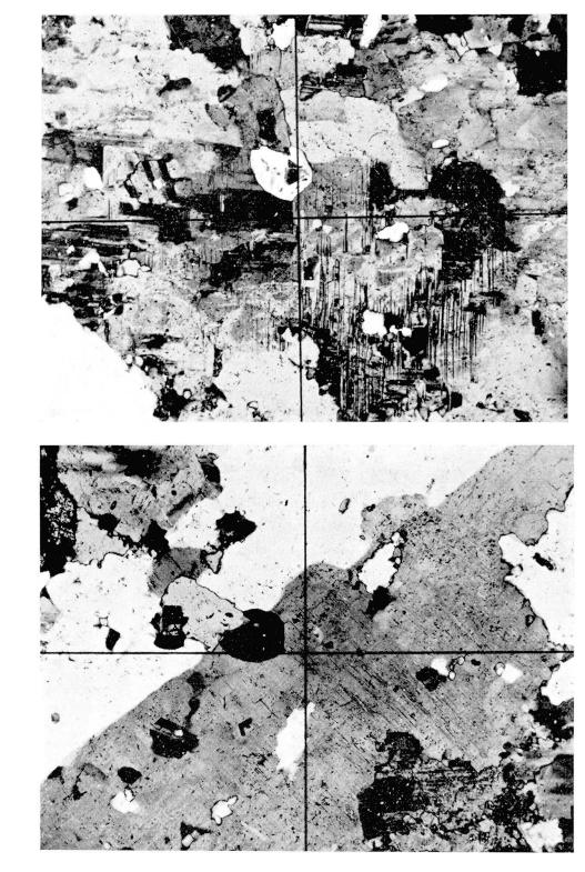
Fig. 2 und 3. Orthoklas aus dem Augit-Granit. In einer Lage kommt die Zerfallstruktur klar hervor, in der anderen ist sie nicht bemerkbar. Die beiden Lagen sind gegeneinander um  $40^\circ$  gedreht. Nic. +, Vergr.  $70\times$ .
