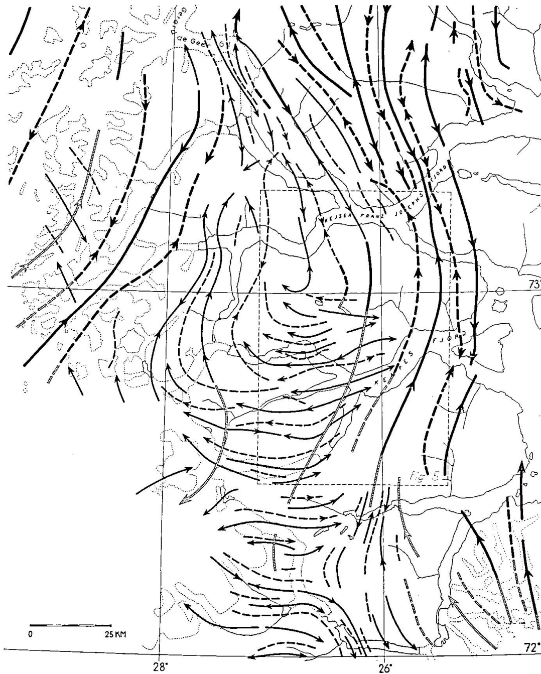
Fig. 4. Strukturkarte der kaledonischen Orogenzone zwischen 72^{\circ} und 73^{\circ}45' n. Br. (vgl. Fig. 1). Die Antiklinalen sind durch ausgezogene Linien, die Synklinalen durch gestrichelte Linien gekennzeichnet. Die Pfeile weisen in der Richtung des Achsenfallens. Die Faltelemente des Unterbaues sind mit dünnen Strichen gezeichnet, die Gewölbe des Oberbaues mit dicken. Wo die Faltenzüge des Oberbaues nur unvollständig erhalten sind, ist der Strich schraffiert.
