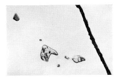
Fig. 3. Allotriomorphe Einschlüsse von Kupferkies in Pyrit. Valleriit (der Anisotropie wegen in der Helligkeit variabel) und Cubanit (etwas dunkler als Kupferkies) im Kupferkies entmischt. 700 ×, Ölimmersion, Gondo.
