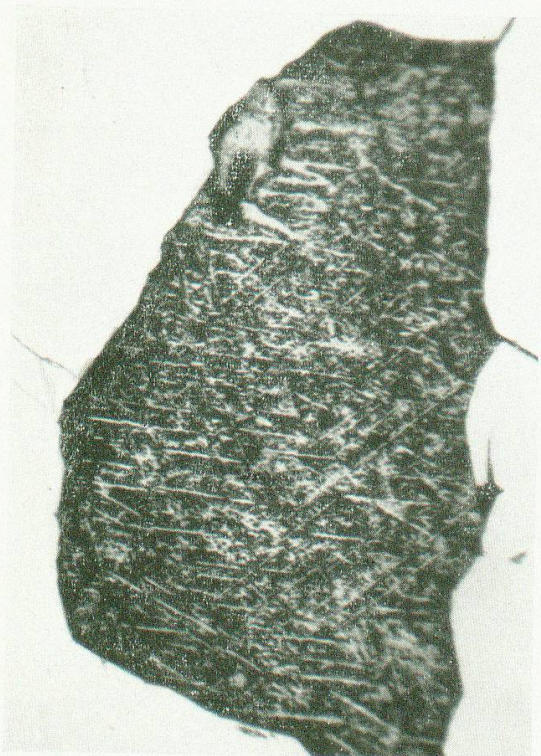
Fig. 6. „Einschluss“ von Schapbachit im Pyriterz von Gondo. Geätzter Anschliff. 750 \times , Ölimmersion.
