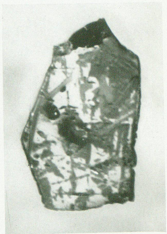
Fig. 10. Schapbachit in Pyrit der Alpe Formazzolo. 700 \times , Ölimmersion.
