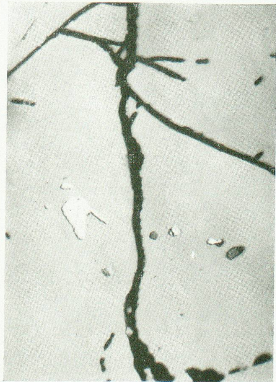
Fig. 7. Einschlüsse von ged. Gold und Kupferkies in Pyrit. 170 \times , Gondo.
