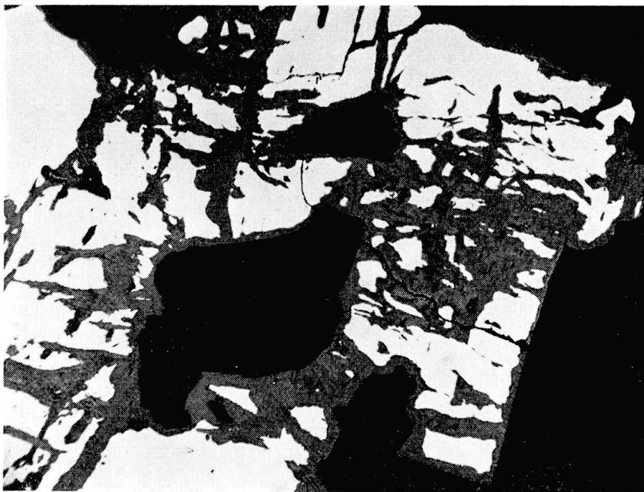
Fig. 2. Verwitterung des Pyrits unter Brauneisenbildung. Deutlich ist zu erkennen, wie die oxydative Verdrängung von Pyrit längs würfeligen Spaltrissen stattfindet. 180 \times , Gondo.
