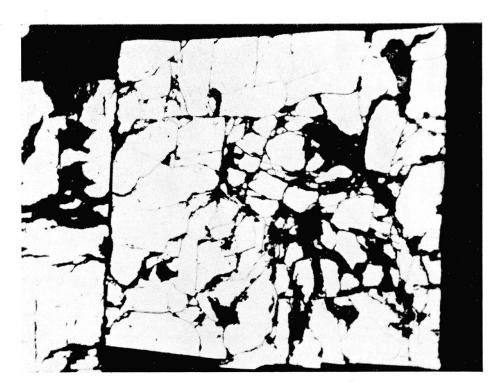
Fig. 1. Kataklastisch deformiertes Pyritkorn, welches nachträglich durch Quarz (hier schwarz) verkittet wurde. 180 ×, Gondo.
