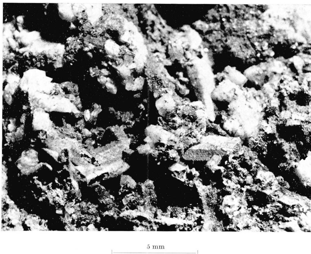
Fig. 2. Man erkennt deutlich den hexagonalen Habitus der Pseudokristalle und, wo dieselben aufgebrochen oder durchlöchert sind, den dunklen Inhalt.
