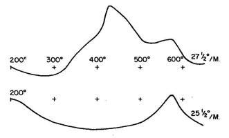
Fig. 4. DTA-Kurve von Stinkfluss in  $\mathrm{HNO_3}$  gekocht, darunter Kurve von Stinkfluss in Stickstoff geglüht.
