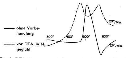
Fig. 3. DTA-Kurven von Pyrit vor und nach dem Glühen in Stickstoff (0.43% Pyrit in  $Al_2O_3$  gegen  $Al_2O_3$ ).
