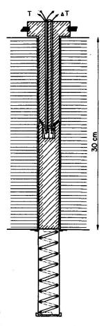
Fig. 1. Schema der Probenanordnung im Ofen. Querschraffur Innenteil des Ofens, Schrägschraffur Steatitkörper, angedeutet Thermoelemente, Platintiegel und Spiralfeder
