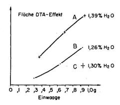
Fig. 3. Beziehung zwischen Grösse des DTA-Effektes und Einwaage bei drei Hornblenden, A Aktinolith Binnental, B grüne Hornblende Finero, C braune Hornblende Mt. Capio.
