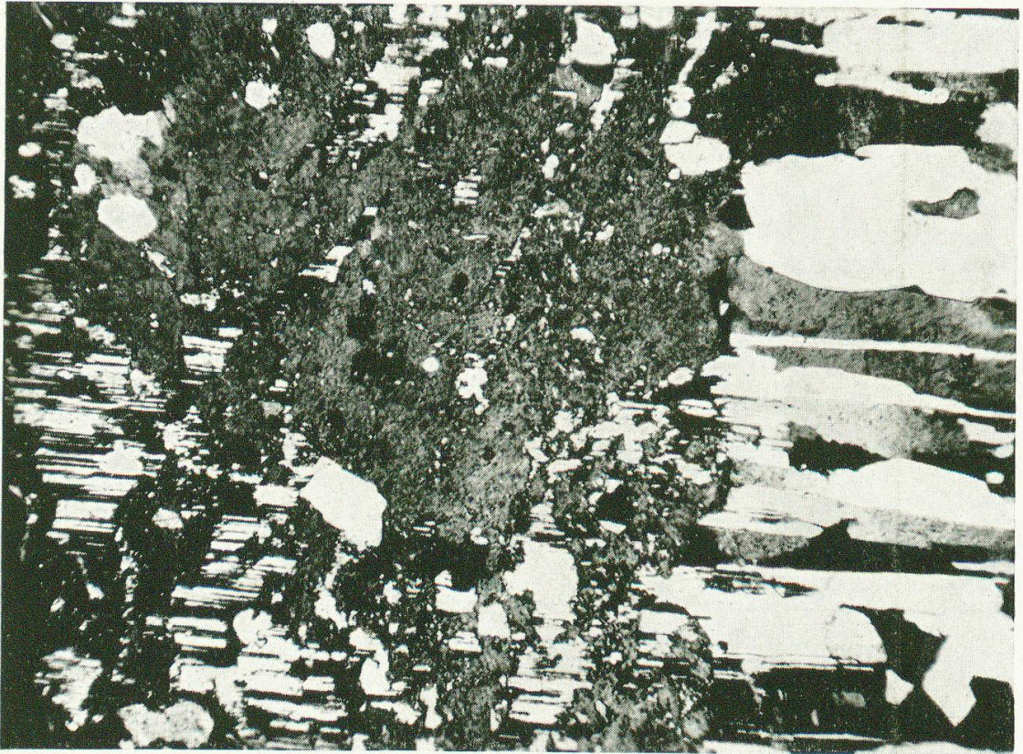
Fig. 3. Kluft mit breitlamelliertem Albit (rechts), der mit Flecken von Schachbrettalbit in Mikroclin (Mitte, feingeschummert) in Verbindung steht. Pegmatit östlich Piz Zavrugia. Vergr. 55\times , + Nicols.
