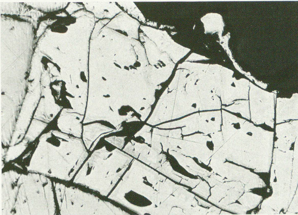
Fig. 4. Vergesellschaftung von Magnetkies (grau) und Pentlandit (hell) mit Bravoitbildungen (hellgrau) in violetter Hornblendeperidotit, Valle di Capolo. Vergr. 180×.
