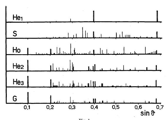
Fig. 1. Strichdiagramme von Manganknollen. Guinier-Aufnahmen mit  ${\rm Fe}_{K\alpha}$ -Strahlung. Bestrahlungsdauer 10—12 Stunden.
