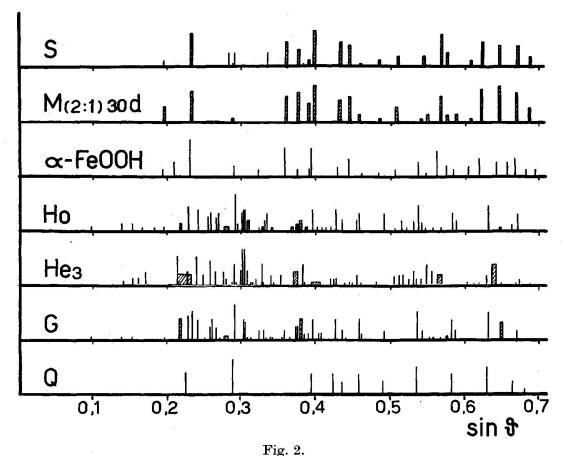
Strichdiagramme der in verd. HCl und Hydroxylamin unlöslichen Rückstände. Guinier-Aufnahmen mit  ${\rm Fe}_{K\alpha}$ -Strahlung. Bestrahlungsdauer 12 Stunden.
