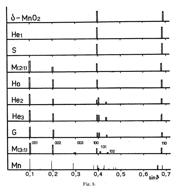
Strichdiagramme von Manganverbindungen in Knollenmaterial sowie von  $\delta$ -MnO<sub>2</sub> und Manganiten.
