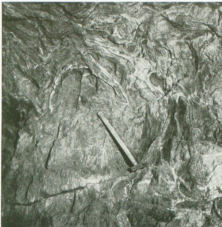
Abb. 1. Biotitgneis (Altkristallin), bänderig und verfältelt (= „migmatitischer Gneis“). Hammer auf schwach nach links geneigter Quarz-Chloritzerrkluft. — Stollen Rotlaur nach Trift, m 2200 (talseitiger Stoss).
