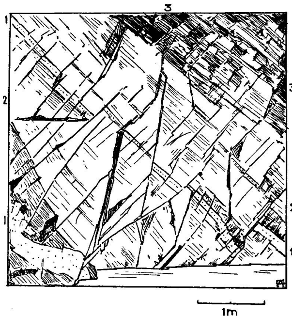
Fig. 7. Porphyrischer Augengneiss mit dünnen aplitischen Lagergängen. Auffallend ist die starke Durchbewegung an zahlreichen kleinsten Bruchflächen. Westliche Hauptstörungszone. Arroyo Calabacito, N von Fundacion
