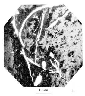
Fig. 1. Anschliffbild: Zeigt die gebogenen Goldbleche (hell) in kalzitischer Gangart (grau) eingewachsen. Stufe Eig. H. A. Stalder.
