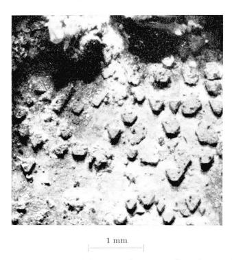
Fig. 3. Goldblechpartie mit parallel angeordneten, mehr oder weniger verzerrten, dem Einkristall-Blech aufgewachsenen Oktaedern. Links unten erscheint die Blechoberfläche angeätzt (horizontal verlaufende, schmale, helle Ziselierungsrillen). Das Blech zeigt Verbiegungen, insbesondere am oberen Bildrand. — Stufe VS 5597 aus Mineralog. Sammlung der ETH, Zürich.
