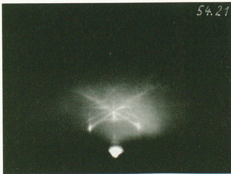
Fig. 1. Unbearbeitete Quarzoberfläche, Quarzinterferenzen und Kikuchilinen.
