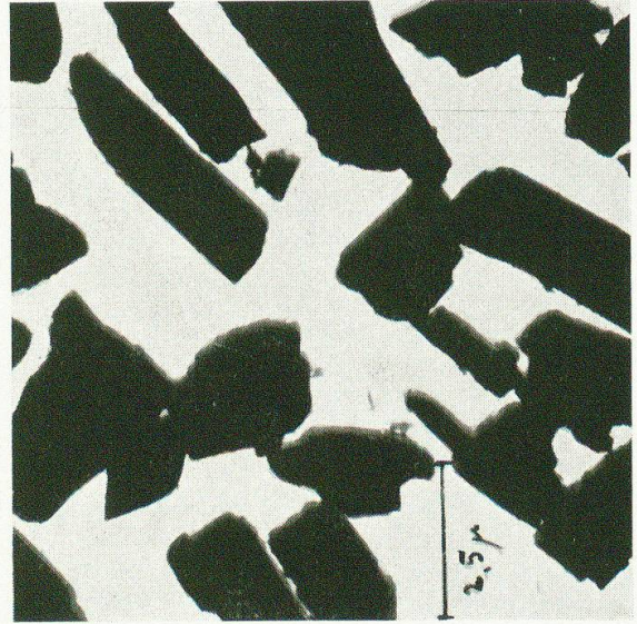
Fig. 6. Tremolit, Hornblendeasbest gemahlen. Elektronenmikroskopische Aufnahme.
