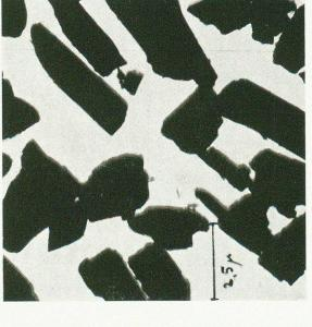
Fig. 6. Tremolit, Hornblendeasbest gemahlen. Elektronenmikroskopische Aufnahme.
