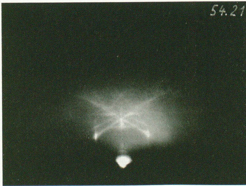
Fig. 1. Unbearbeitete Quarzoberfläche. Quarzinterferenzen und Kikuchilinien.
