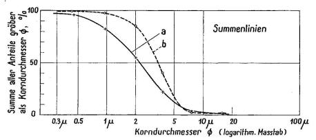
Fig. 7. Vergleichender Schlämmversuch von Quarz. a = in Wasser, b = in physiologischer NaCl-Lösung.
