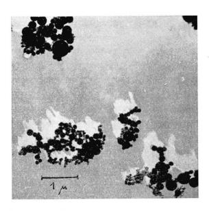
Fig. 11. Elektronenmikroskopische Aufnahme von Quarzrauch.
