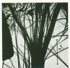
Fig. 5. Elektronenmikroskopische Aufnahme von Chrysotilasbest.
