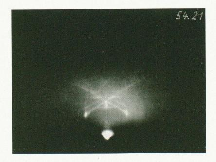
Fig. 1. Unbearbeitete Quarzoberfläche. Quarzinterferenzen und Kikuchilinien.
