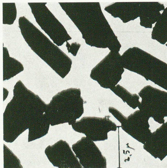
Fig. 6. Tremolit, Hornblendasbest gemahlen. Elektronenmikroskopische Aufnahme.
