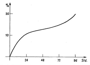
Fig. 5. Zeitlicher Lösungsverlauf von Quarz  $< 5 \mu$  in  $H_2SiF_6$ .
