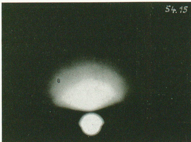
Fig. 3. Quarz mit Corund poliert. Quarzinterferenzen verschwunden. Polierschicht von mehr als 40 Å Dicke.
