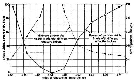
Fig. 2. Sichtbarkeit von Quarzteilchen in Einbettungsmedien mit verschiedenen Brechungsindizes (Hellfeld) (nach Foster).
