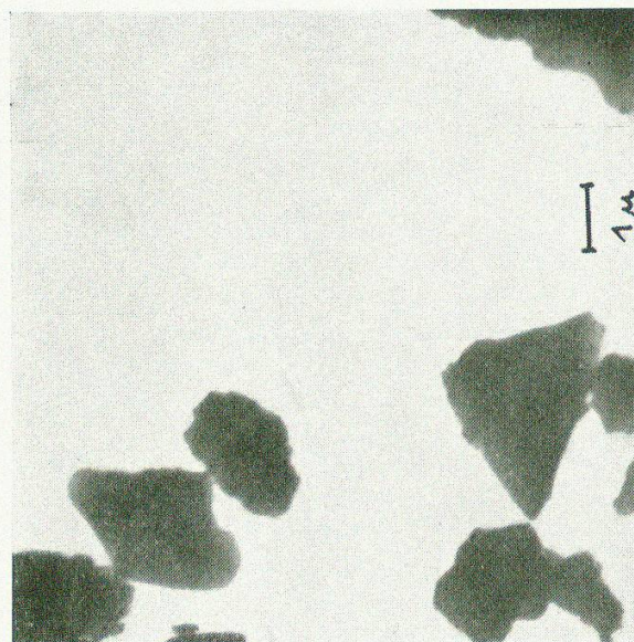
Fig. 4. Quarz leicht mit HF geätzt. Elektronenmikroskopische Aufnahme
