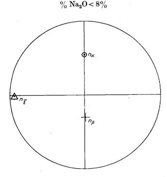
Fig. 3. Position moyenne des directions de  $n_{\alpha}$ ,  $n_{\beta}$  et  $n_{\gamma}$  dans les grains de microcline. Le plan de projection est la face de support des grains.
