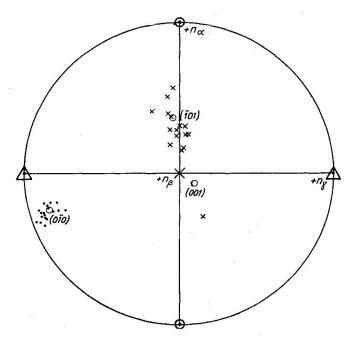
Fig. 2. Ensemble des mesures faites à la platine de Fédoroff. Points: pôles des faces mesurées; croix: pôles des faces de support des grains; cercles: pôles du microcline d'après Nikitin (1936).
