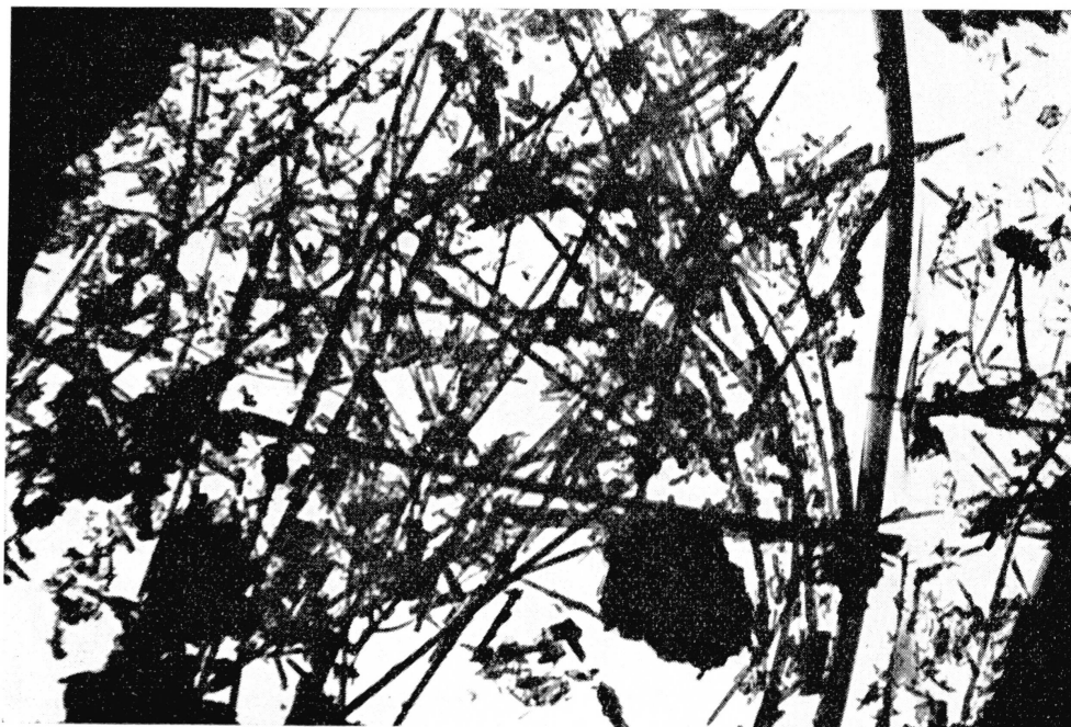
Fig. 2. Chrysotil aus Versuch 304, in 20000facher Vergrößerung (Elektronenmikroskop. Aufnahme)
