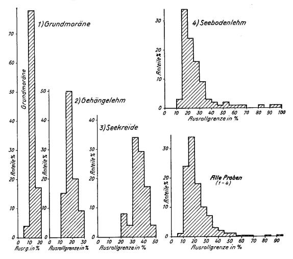
Fig. 2. Ausrollgrenzen der bautechnisch häufigst getroffenen Bodenarten der Schweiz
