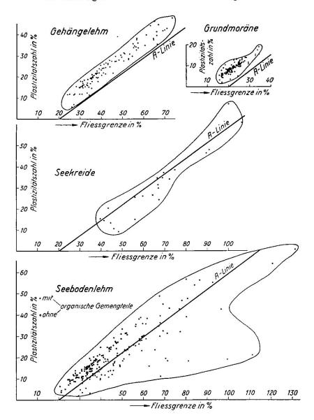
Fig. 4. Diagramme der Konsistenzgrenzen schweizerischer bindiger Lockergesteine
