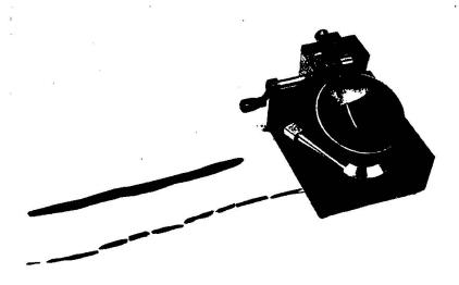
Fig. I. Apparat zur Bestimmung der Fließgrenze nach A. CASAGRANDE (neue Form). Links Bestimmung der Ausrollgrenze.
