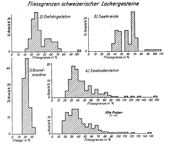
Fig. 3. Fließgrenzen der bautechnisch häufigst getroffenen Bodenarten der Schweiz
