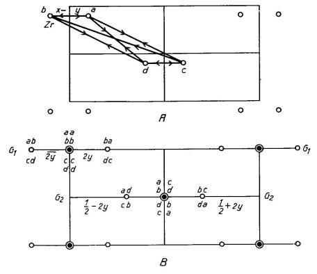
Fig. 1. A. Kristallraum  $C_s^3$ -Cm mit allgemeiner Punktlage a, b, c, d B. Harker-Maxima des zugehörigen Pattersonraumes: (000) und  $(\frac{1}{2}, \frac{1}{2}, 0)$  mit dem Gewicht  $4 Z_r^2$ ; (0, 2y, 0), (0,  $\overline{2y}$ , 0),  $(\frac{1}{2}, \frac{1}{2} + 2y, 0)$  und  $(\frac{1}{2}, \frac{1}{2} - 2y, 0)$  mit dem Gewicht  $2 Z_r^2$ .
