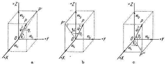
Fig. 4. Beziehungen zwischen den sphärischen Koordinaten  $(\xi, \eta)$  eines Punktes Pauf der Kugeloberfläche und seinen auf ein Rechtssystem XYZ bezogenen cartesianischen Koordinaten (x, y, z). a) Die Äquatorebene liegt in der Koordinatenebene YZ, b) sie liegt in XZ, c) sie liegt in XY.
