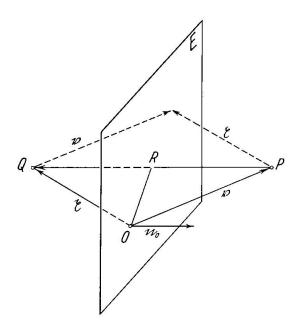
Fig. 8. Spiegelung des durch seinen Ortsvektor v gegebenen Punktes P an einer durch ihren Normalvektor n bestimmten Ebene E. Berechnung des Ortsvektors z des gespiegelten Punktes Q.
