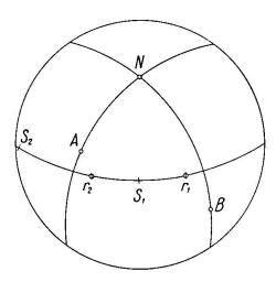
Fig. 10. Fresnel'sche Konstruktion in neuer, für die vektorielle Behandlung geeigneter Variante. Die beiden der Wellennormalrichtung N zugeordneten Schwingunsrichtungen S<sub>1</sub> und S<sub>2</sub> sind die Halbierungspunkte der durch r<sub>1</sub> und r<sub>2</sub> eingeschlossenen räumlichen Winkel. r<sub>1</sub> und r<sub>2</sub> sind ihrerseits die Pole der beiden durch den Pol von N und diejenigen der beiden optischen Achsen A und B gelegten Grosskreise.
