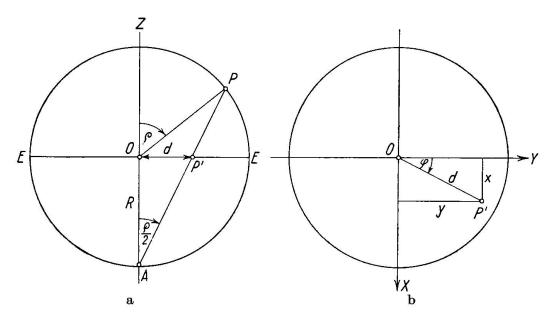
Fig. 7. Entwurf eines Stereogrammes unter Benützung rechtwinkliger Koordinaten. a) Schnitt der Projektionskugel normal zur Zeichenebene EE. b) Schnitt der Projektionskugel parallel zur Zeichenebene.
