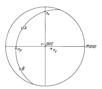
Fig. 6. Stereographische Projektion auf die Ebene  $\perp$  [001] für Albit, gezeichnet auf Grund der aus den gegebenen Achsenpositionen errechneten  $\varphi$ ,  $\rho$ -Werte für die Hauptschwingungsrichtungen.
