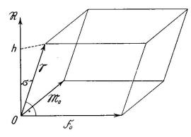
Fig. 11. Der Auslöschungswinkel  $\sigma$  ist gleich der Schiefe des durch die drei Vektoren  $\mathfrak{F}_0$  (Einheitsnormalvektor der betrachteten Fläche F),  $\mathfrak{M}_0$  (Einheitsnormalvektor der Bezugsfläche M) und  $\mathfrak{S}$  (Schwingungsrichtung) aufgespannten Parallelepipeds mit der
