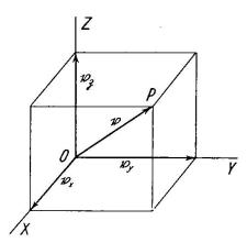
Fig. 2. Zerlegung eines Vektors b in drei zu XYZ parallele Komponenten.
