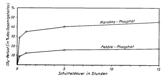
Fig. 3. CO<sub>2</sub>-Verlustkurven der Rohphosphate Marokko und Pebble bei Behandlung mit verdünnter Essigsäure.
