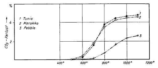
Fig. 2. CO<sub>2</sub>-Verlustkurven der Rohphosphate Tunis, Marokko und Pebble.
