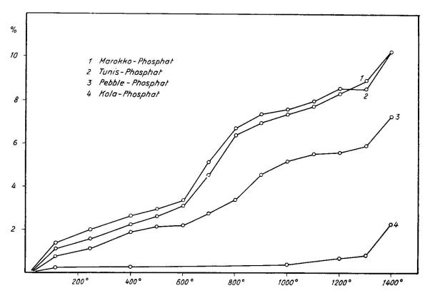
Fig. 1. Glühverlustkurven der Rohphosphate Marokko, Tunis, Pebble und Kola.
