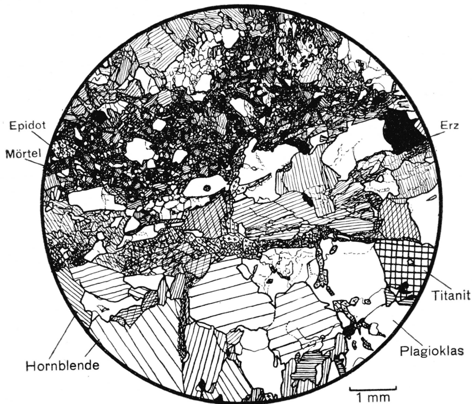
Fig. 31. Hornblendedioritbreccie (Schliff Nr. 2251) südlich Pizzo Leone, nördliche Randzone. Strukturtypus IV b; partienweise unzertrümmert (Strukturtypus Ia), teils vollständig mylonitisiert zu fast isotropem Mörtel mit eckigen Bruchstücken von Hornblende und Albit. Längs gewissen Zonen Neubildungen von Epidot, der z. T. auch mylonitisiert ist.
