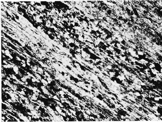
Fig. 46. Glimmerschiefer (Schliff von RADEFF Nr. 29a), Valle Remagliasca, Südseite der Canavesezone. Feinkörnige, aber ziemlich regelmässige granoblastische bis lepidoblastische Struktur. (Vergrösserung ca. 25-fach, gekr. Nicols.)
