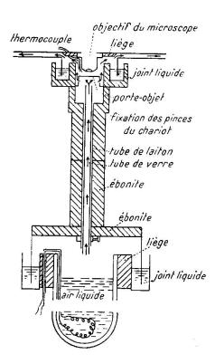
Rothery et D. J. Strawbridge pour une chambre Debye 1). L'appareil étant destiné à étudier les transformations paramorphiques, la température peut être réglée en faisant varier l'intensité du courant dans la résistance chauffante depuis quelques dixièmes jusqu'à 100 V.A. Cette énergie maximum permet d'atteindre — 120 º en une trentaine de minutes. L'abaissement de température peut être plus lent: un à deux degrés par minute. Plus la température est
