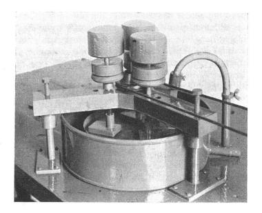
Fig. 2. Dispositif automatique à meuler. Vue d'ensemble.
