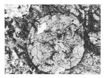
Abb. 17. Chloritoid-Smirgel mit sphärischen Chloritoid-Bezirken (Taşkesiği). Vergr.: 35 ×.
