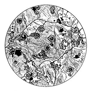
Abb. 12. Erzarmer Smirgel. Korunde punktiert (äusserst feine Magnetiteinschlüsse), Diaspor weiss, Chloritoid (rosettenförmig) radial gestrichelt,
