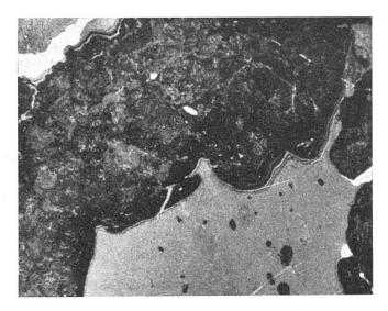
Abb. 30. Merismitisch texturierter Diasporit (Gümüşkesen). Vergr.: 7,2 ×.
