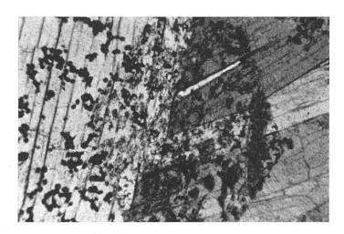
Abb.25. Diaspor pseudomorph nach Korund in diasporisiertem Smirgel. Die sechsseitigen Umrisse des Korundes sind durch Rutilansammlungen und Korundreste verdeutlicht.
