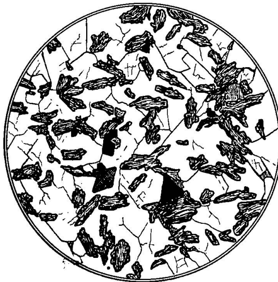
Abb. 14. Chloritoidführender erzarmer Smirgel. Korund weiss mit Rissen und Korngrenzen, Chloritoid starkgestrichelt, Høgbomit kariert, Magnetit schwarz, Goethit (an Magnetit) punktiert, Diaspor schwachgestrichelt. Grube Eğlidağ. Vergr.: 125×.
