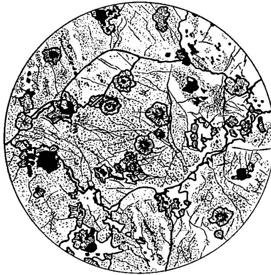
Abb. 12. Erzarmer Smirgel. Korunde punktiert (äusserst feine Magnetiteinschlüsse), Diaspor weiss, Chloritoid (rosettenförmig) radial gestrichelt, Magnetit schwarz. Grube Karandere. Vergr.: 55×
