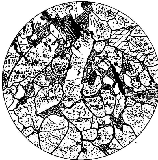
Abb. 13. Erzarmer Smirgel, mit Ilmenit (schwarz), Diaspor (feingestrichelt), Høgbomit (kariert), Karbonat mit breiten Streifen und Korunde punktiert (Einschlüsse). Yatıganocak. Vergr.: 55×
