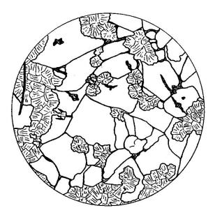
Abb. 15. Chloritoid-Smirgel (Akçakavaklar). Korund weiss, Chloritoid radialgestrichelt, Diaspor enggestrichelt. Vergr.: 55 ×.
