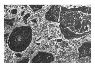
Abb. 31. Korundführender Diasporit (Koçak). Kleine Korunde (weiss) mit scharfen Rissen und stärkerem Relief. Sehr feine Diaspor-Grundmasse mit fleckiger Verteilung der Einschlüsse (teils hell, teils dunkelgrau). Chloritoide (hier kaum erkennbar). Blastopisolithische Gebilde (sehr dunkelgrau bis schwarz). Vergr.: 7,3 ×.
