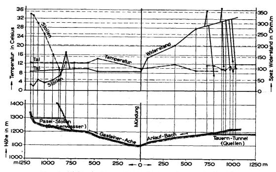
Fig. 4. Elektrohydrographische Untersuchungen in Gastein
