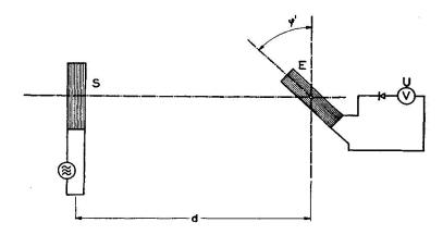
Fig. 13. Funkmutungsgerät nach dem Ausbreitungsverfahren mit nahem Sender
